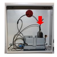
Im zweiten Fach der Ladeschale befindet sich ein Reserve-Akku-Pack, dass Sie bei Bedarf in den Taschensender einlegen können. Bitte stecken Sie das leere Akku-Pack zum Aufladen wieder in die Ladeschale.
