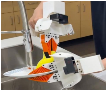
Abbildung 1: Zwei UMI-Greifer beim Demonstrieren eines Geschirrspülvorgangs.
